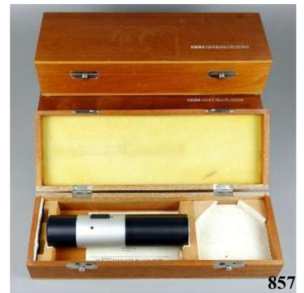
857 3x FT PISTONFON PF 101 TYP 00003 Mikrofontechnik Gefell Präzisionskalibrator zur Absolutkalibrierung von Schallmessgeräten, Hersteller, VEB Messelektronik "Otto Schön", Dresden, jeweils in Holzetui, unvollständig 50,00 €
